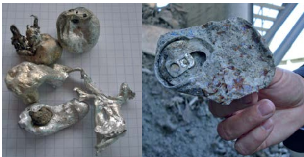
Alluminio fuso e lattine recuperate dalle scorie (foto gentilmente fornita da EAA)
